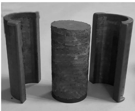
Рис. 3. Образец закрепленного грунта после извлечения из гильзы
