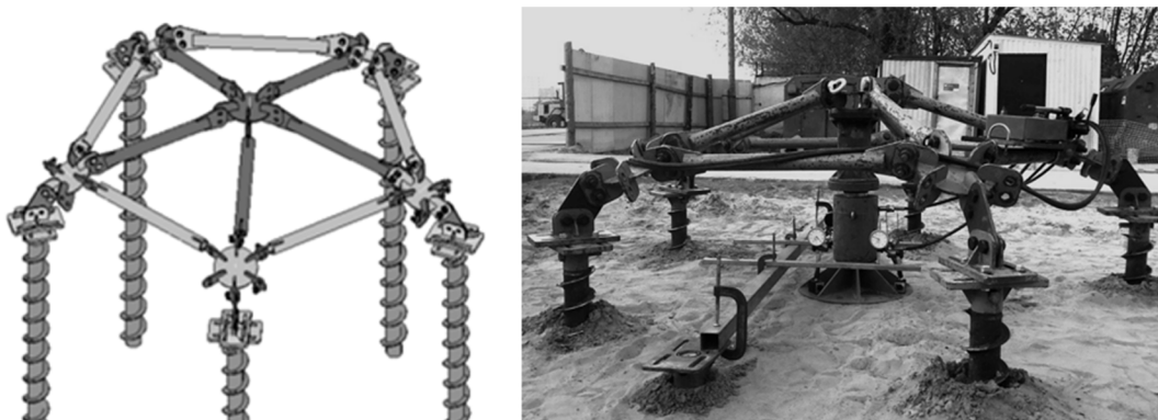
Рис. 4. Новая конструкция для проведения статических испытаний грунтов штампами нагрузкой до 30 т:
