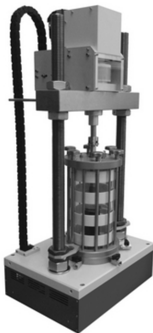
Рис. 1. Общий вид прибора трехосного сжатия (вибростабилометр) GDS ELDYN
