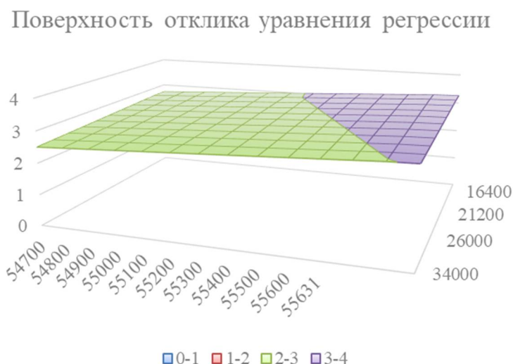
Рис. 2. Поверхность отклика уравнения регрессии, показывающего зависимость осадки от жесткости сваи и модуля упругости грунта основания
